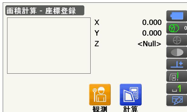
画地を囲む点の1点目を視準して、【測定】を押します。【停止】を押して測定を終了します。
