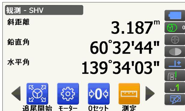
測距が始まり、測定した距離、鉛直角、水平角が表示されます。
