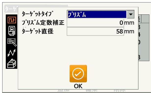
・「プリズム定数補正值」は、「距離最小表示」の設定が0.1mmのとき小数第一位まで入力できます。
