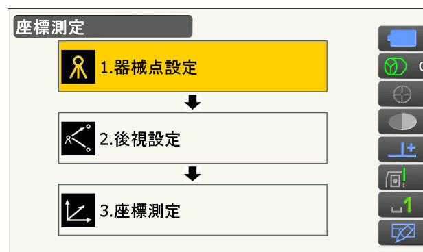
機械を設置した測点（器械点）の座標、器械高、視準高を入力します。
