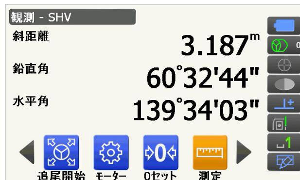
指定角旋回をさせるための鉛直角と水平角を入力します。
