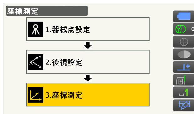
【測定】を押すと測定を開始します。【停止】を押して測定を終了します。目標点の座標値が表示されます。
