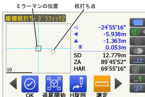
杭打ち点までの距離が 0m になる位置までターゲットを移動させて杭打ち点を探します。
