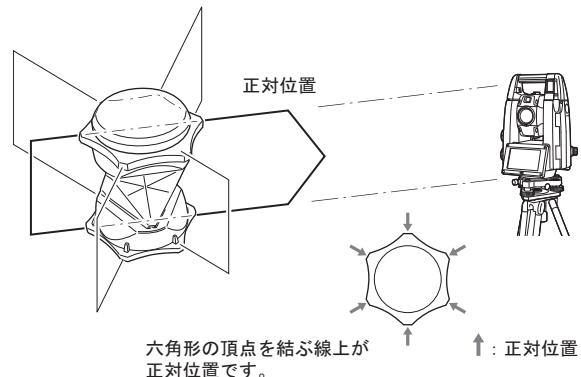
360° スライドプリズム (ATP1SII) の場合は、プリズム上面の 6 本の印を直線に結ぶ線上が、水平方向の正対位置です。
