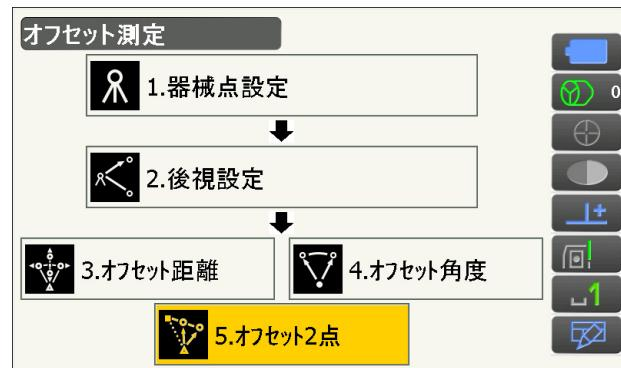
【設定】を押してオフセット点の設定をします。オフセット点 B から求点までの距離を「オフセット距離」に入力し、ターゲットを設定します。入力後は【OK】を押します。
