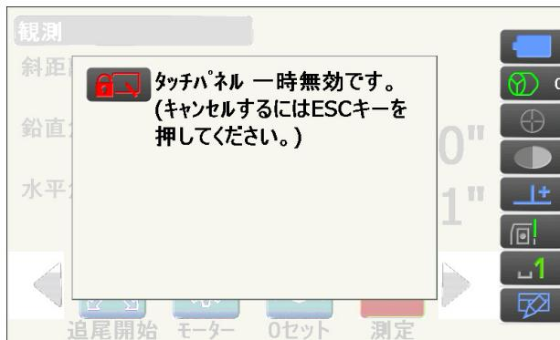
表示中はタッチパネルの操作が無効になります。**(ESC)** を押すと画面は閉じ、タッチパネルの操作が有効になります。
