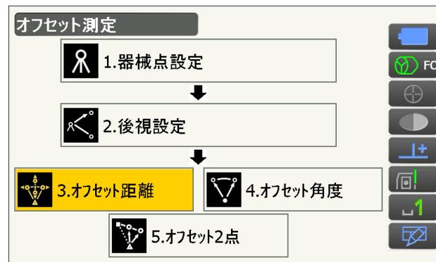
オフセット方向（オフセット点の求点との位置関係）とオフセット距離（オフセット点と求点の距離）を設定します。
