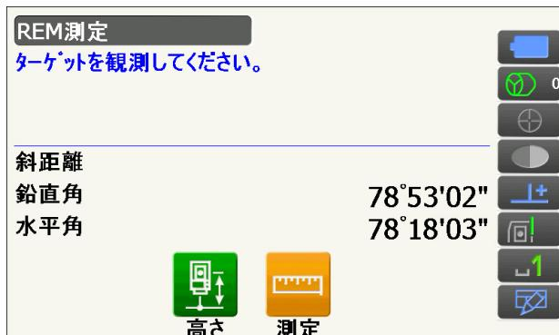
測定した距離・鉛直角・水平角が表示されます。
