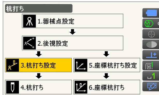
「目標水平角」に基準の方向と杭打ち点の夾角を、「目標斜距離」に原点（器械点）から杭打ち点までの距離を目的に応じた距離モードで入力します。入力後は【OK】を押します。
