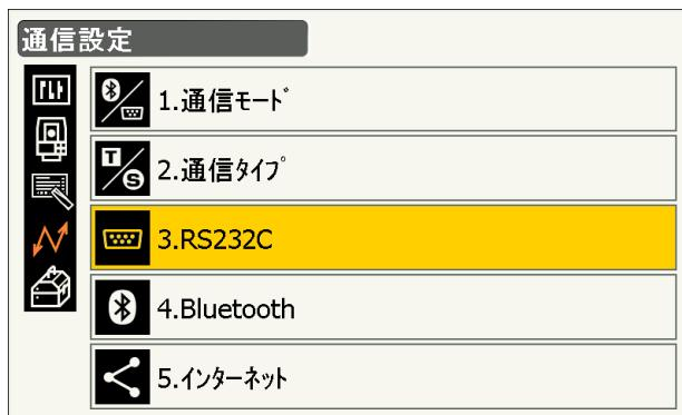
通信条件に合わせて RS232C の通信条件を設定します。
