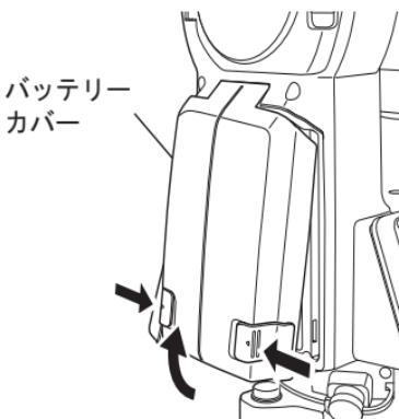
2. バッテリーの矢印の方向を下にして、バッテリーを本体に押し付けて装着する
