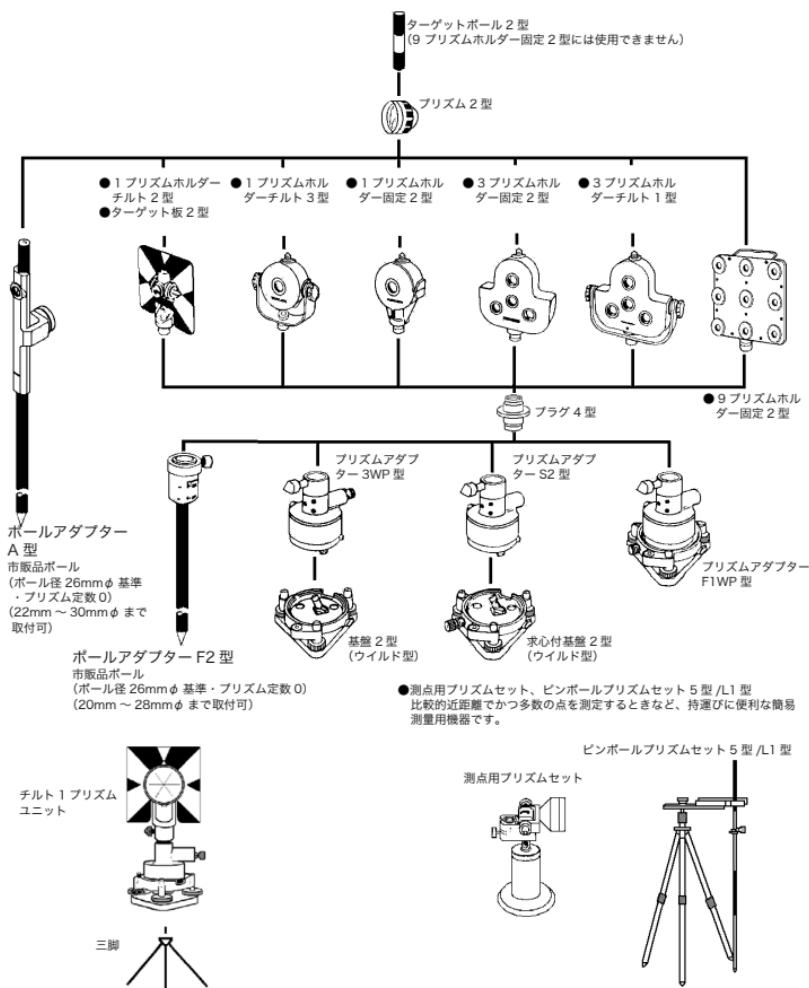
プリズムアダプター3WP型、S2型およびF1WP型は、プラグ4型を使用することにより、ESと高さを合わせることができます。プリズムユニットの高さ調整は、プリズムアダプターのビスの固定位置を変えることにより行います。(2段階の調整になっていますが、ESには全高が一番低くなるところにします。)
