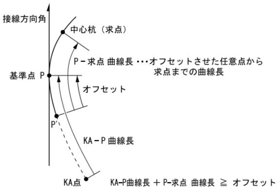
KE2 点を基準とした計算：「KE → KA 計算」
