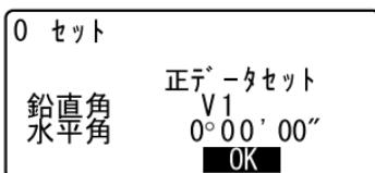
その後、画面には電子気泡管が表示されます。機械を整準をして【OK】を押すと観測モードになります。
