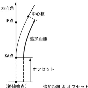
KA1 点と KE1 点の間の任意点を基準とした計算：「KA → KE 計算 2」
