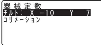
(ENT) を押すと現在の X 方向（視準方向）の傾斜角、Y 方向（横軸方向）の傾斜角が表示されます。
