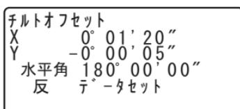
7. そのままの状態で以下のオフセット値(傾斜センサーの0点のずれ量)を計算する
