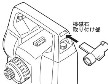
✿：棒磁石は、周囲の磁気や金属の影響を受けますので、正確な磁北を決定することはできません。棒磁石が示す磁北を測量の際の基準として使用しないでください。
