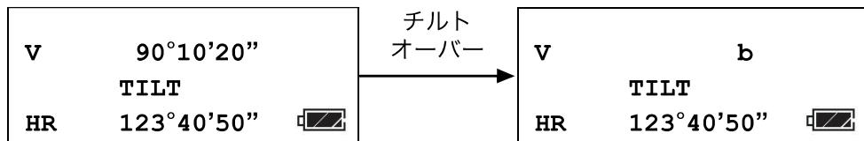
安定しない台や風が強いときは、鉛直角の表示が安定しないことがあります。このときは自動補正（チルト）を停止してご使用になります。また精密な測定を行うときはチルト補正 ON で使用してください。（工場出荷時は、チルト補正 ON になっています。）
