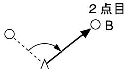
求める B の水平角と鉛直角が表示されます。
