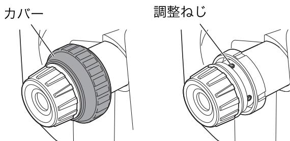
3. 残りのずれ量を求心望遠鏡についている 4 本の調整ねじで修正する
