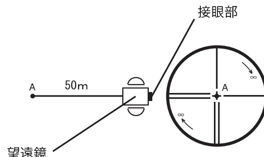
3. 望遠鏡固定つまみをゆるめて望遠鏡を 180° 回転し、
