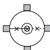
4. 本体上部を回転しても、測点が求心望遠鏡の二重丸の中央からずれていないことを確認する
