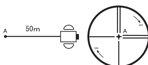
5. 望遠鏡固定つまみをゆるめて、望遠鏡を 180° 回転
