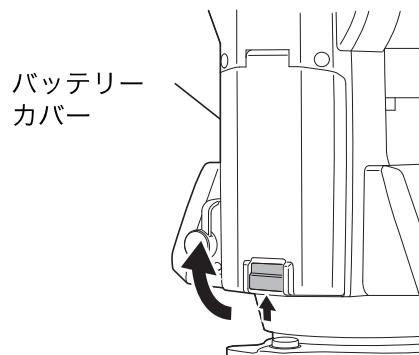
2. バッテリーの端子の向きを確認して、本体に押し付けて装着する
